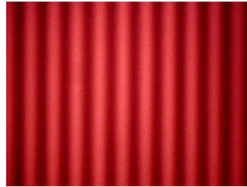
Figura 3. Franjas de Lau obtenidas empleando como red objeto una red almacenada en un cristal fotorrefractivo tipo BSO
