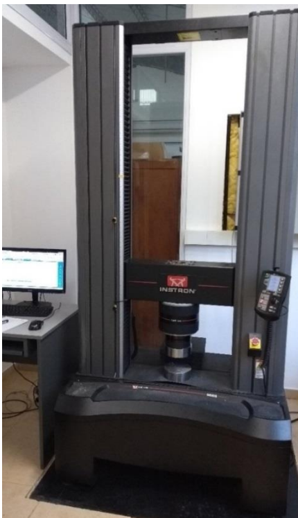
Figura 28. Máquina utilizada para realizar el método de flexión en tres puntos sobre las probetas sinterizadas.
