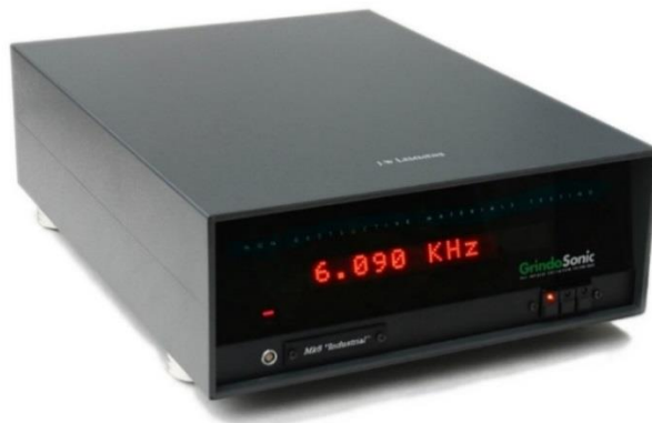
Figura 25. Equipo de ensayo de módulo de elasticidad por excitación por impulso Grindosonic modelo Industrial.
