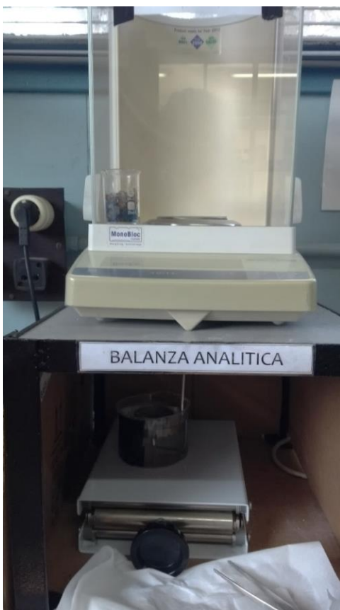
Figura 16. Equipo y balanza analítica utilizados en el método de Arquímedes.
