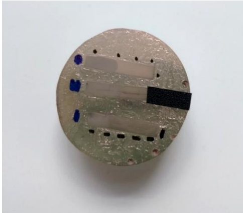
Figura 22. Muestras con un ataque ácido parcial (etching químico) sobre la superficie de las piezas y metalizadas con oro.
