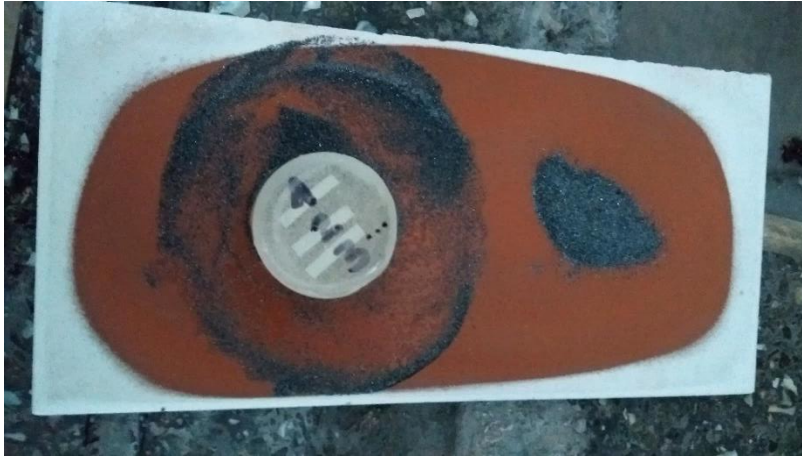
Figura 20. Desbastado con polvo de carburo de silicio de las muestras incluidas en resina.
