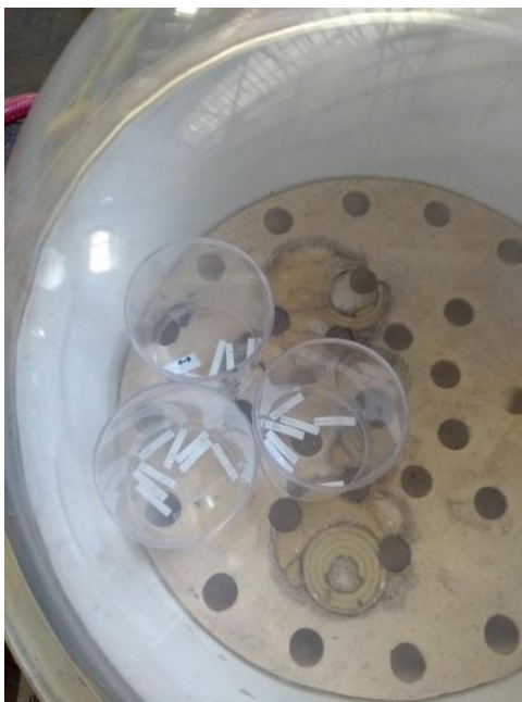
Figura 15. Piezas sumergidas en agua y en vacío.
