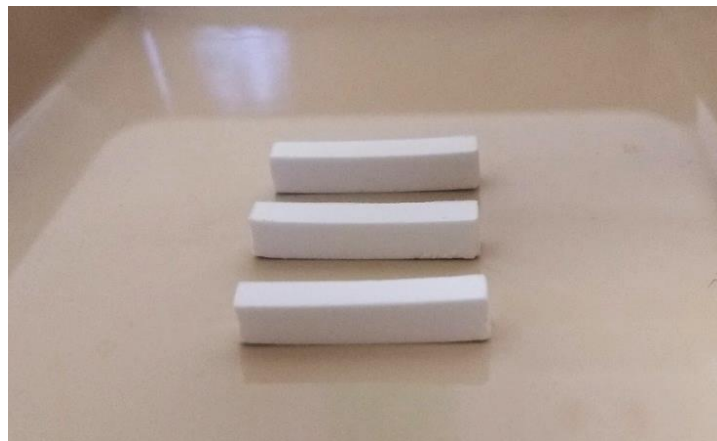
Figura 10. Probetas sinterizadas a 1400°C en horno eléctrico.
