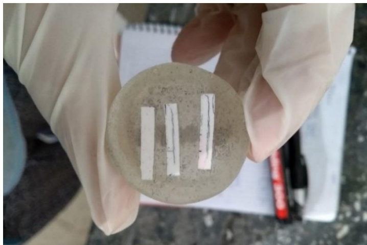
Figura 21. Muestras incluidas en resina, desbastada y pulida.
