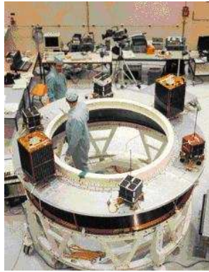
Figura 1: Cargas útiles secundarias, montadas sobre una de las partes de un lanzador
