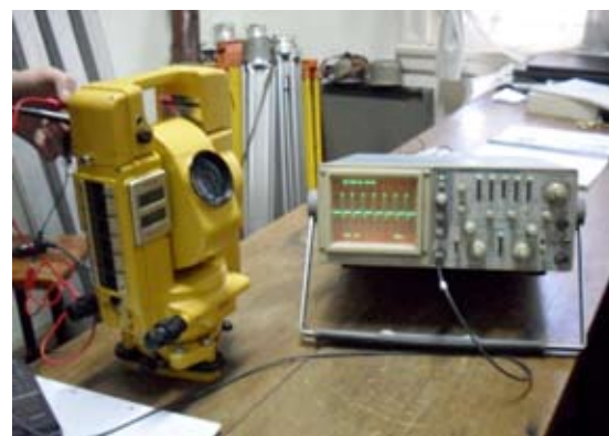
Figura 4. Imagen del osciloscopio conectado a la estación total y la forma de onda de la señal del oscilador interno.
