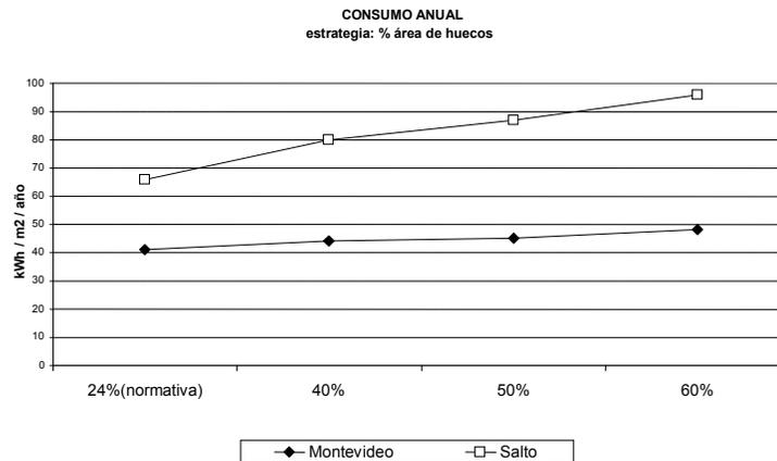
Fig. 7. Consumo anual de energía según % de área de hueco, modelo mono orientado, Montevideo y Salto
