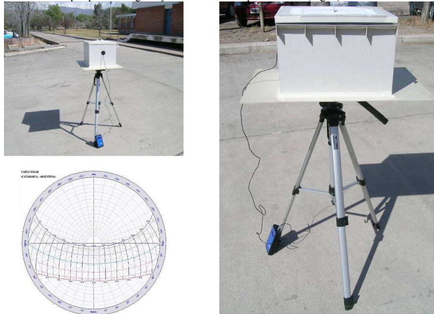
Figura 7. Maqueta en posición de mediciones y carta solar.
