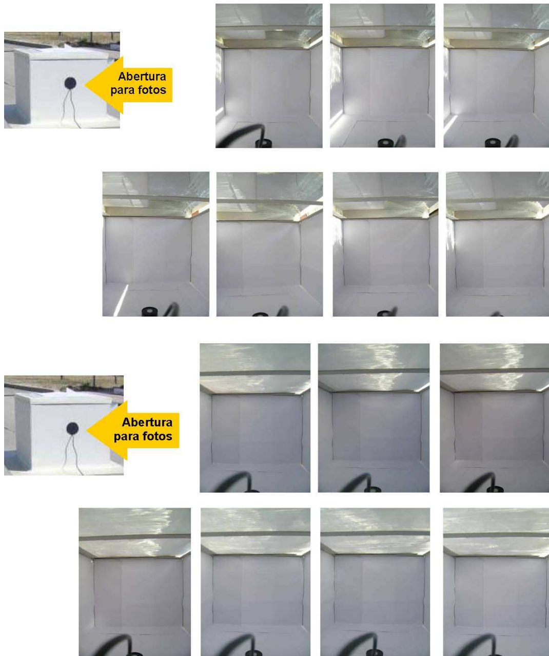
Figura 8. Registros fotográficos interiores. Primera serie de fotos sin cielorraso difusor, segunda serie correspondiente a luz solar difundida por cielorraso suspendido.
