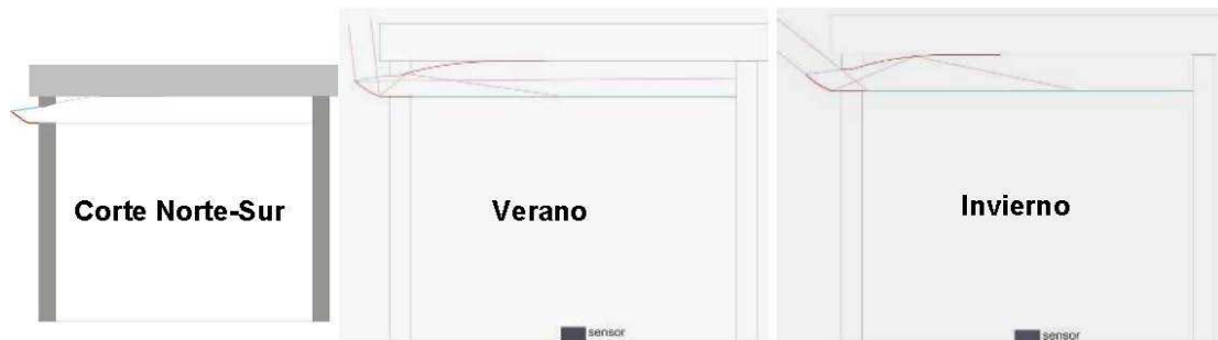
Figura 5. Corte Norte Sur. Trayectoria de rayos solares verano e invierno.
