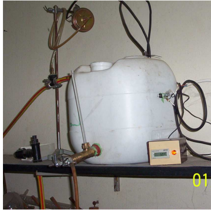
Figura N° 1: Equipo de calentamiento de agua para calefacción del reactor y circuito eléctrico
