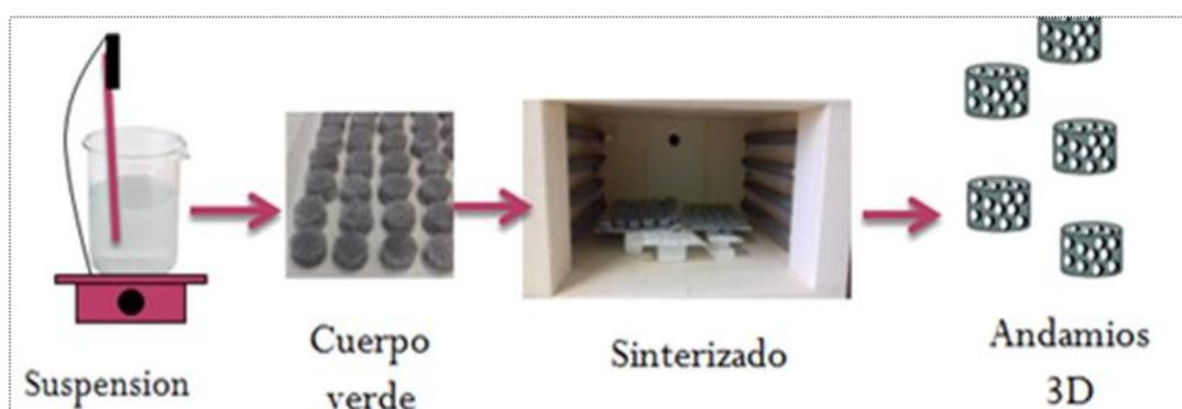
**Figura 5.1.** Esquema de la síntesis utilizada para la obtención de los andamios 3D a base de vidrio bioactivo 45S5<sup>®</sup>.
