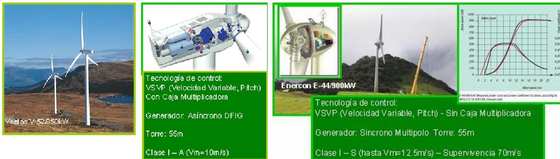
Figura 7 – Equipos Vestas V-52 y Enercon E-44 los equipos seleccionados
