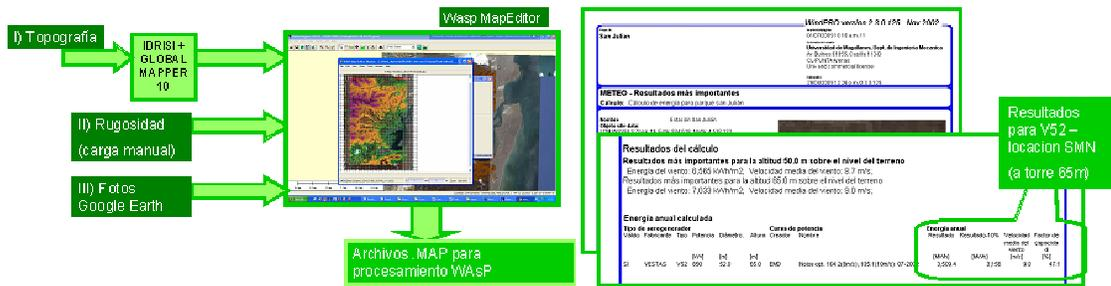
Figura 6 – Insumos y Procesamiento con WAsP Map Editor, verificación con WindPro
