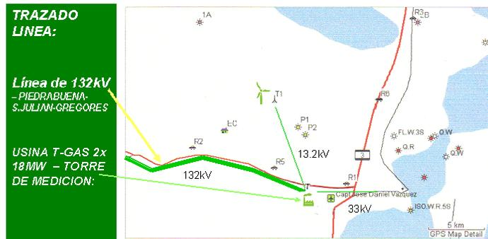
Figura 9 – Esquema de red proyectada para la zona
