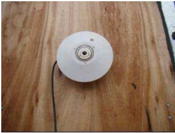
Foto 5: Piranómetro ubicado en plano vertical
