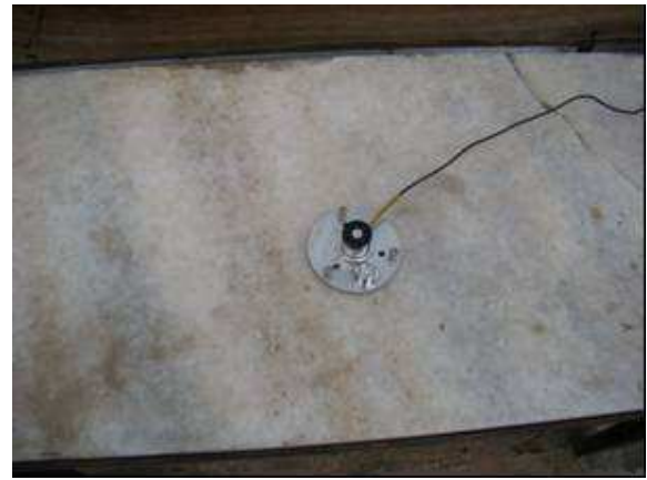
Foto 6: Piranómetro sobre plano horizontal
