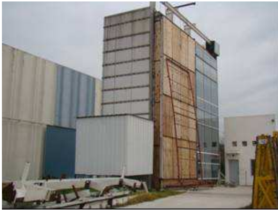
Foto 1: Cámara de ensayos con la fachada vidriada instalada.
