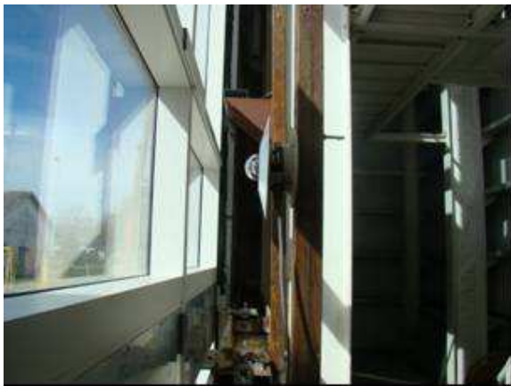
Foto 1: Cámara de ensayos con la fachada vidriada instalada.
