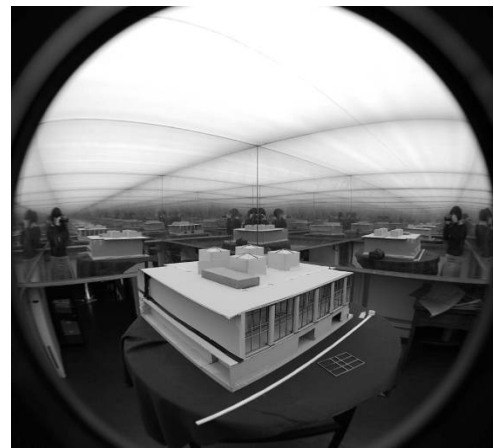
Fig. 4 y 5. Fotografías del modelo a escala 1:50 del edificio INEFC, en el Cielo Artificial (CIHE-FADU-UBA)
