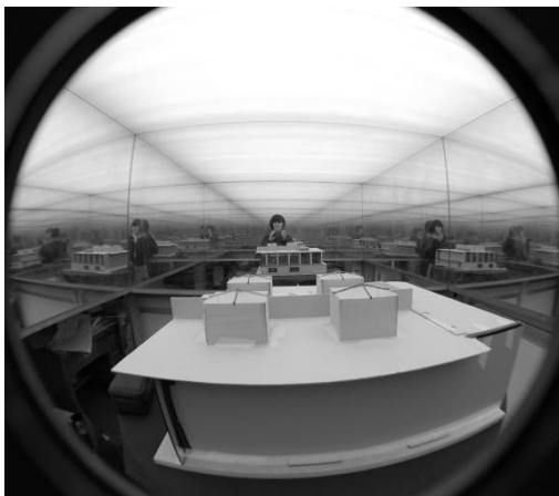
Fig. 4 y 5. Fotografías del modelo a escala 1:50 del edificio INEFC, en el Cielo Artificial (CIHE-FADU-UBA)
