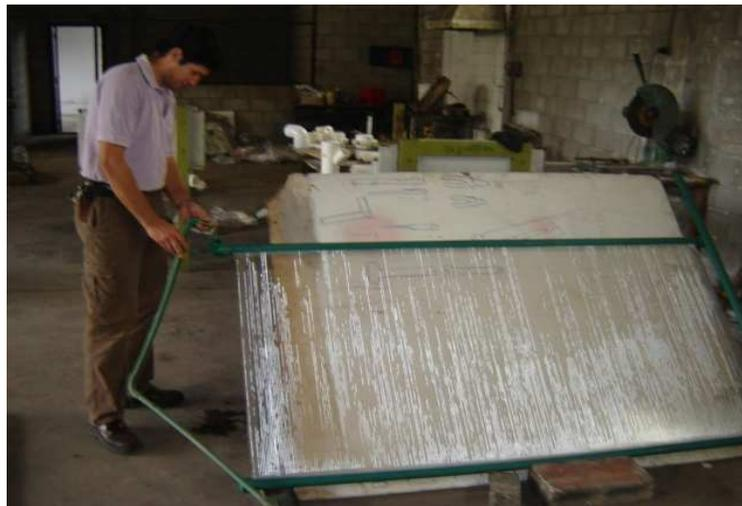
*Figura 4 - La primer prueba hidráulica. Posteriormente se realizaron otras pruebas, elevando la columna de agua a 2 m de altura.*
