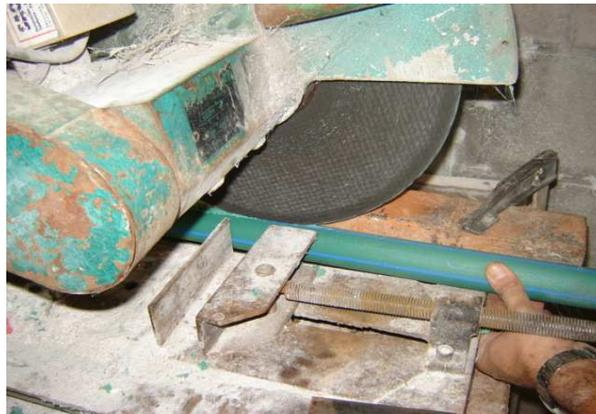
*Figura 2 - ranurado de caño con máquina sensitiva. Pueden observarse las guías que permiten que la ranura sea realizada lo más rectilínea posible y de esta forma obtener un mejor sellado entre la cañería y la plancha de policarbonato*
