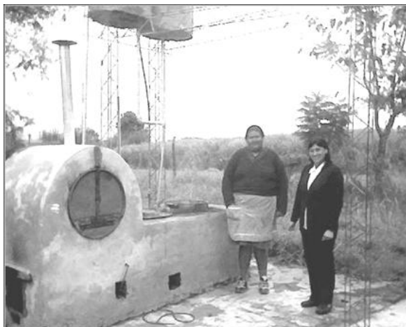
Imagen 1 – UICHE CCA - Unidad Integrada Cocina Horno Eficiente con Calentamiento de Agua
