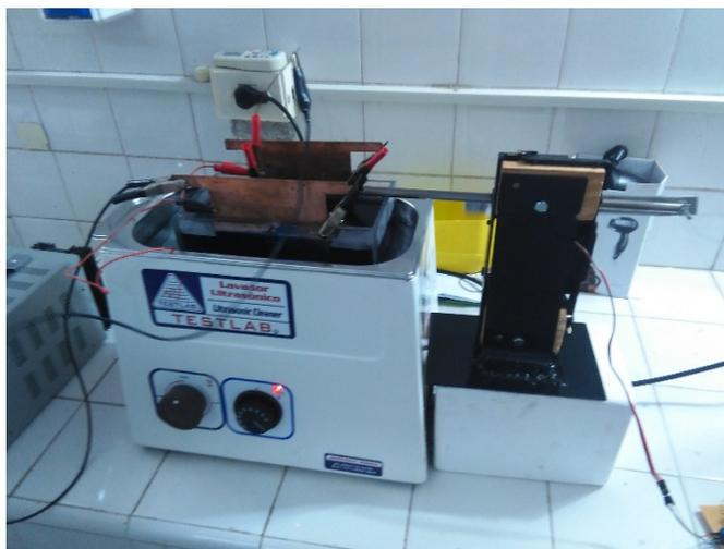
Figura 7: Fotografía de la celda de cátodo oscilante
