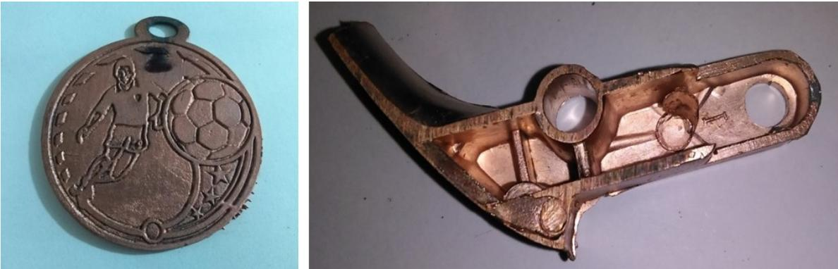
Figura 8: medalla (6 cm diámetro) y manija de cierre de puerta de automóvil (longitud=8 cm) de Zamak recubierta con 10  $\mu\text{m}$  de cobre en celda cátodo oscilante.
