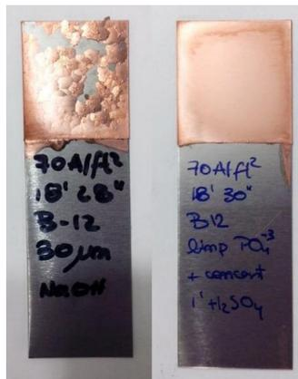
Figura 4. Comparación del efecto de la limpieza superficial previa en la adherencia. Ensayos 31 (izquierda) y 36 (derecha) a  $70 \text{ A/ft}^2$ .
