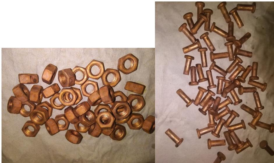
Figura 11. Fotografía de pequeñas piezas cobreadas en tambor rotante (tuercas de 1.25 cm de diámetro y remaches de 1.50 cm de largo).
