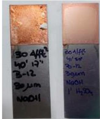
Figura 3. Comparación del efecto de aumento de decapado ácido desde 15 segundos en el ensayo 25 (izquierda) a 60 segundos en el ensayo 32 (derecha).
