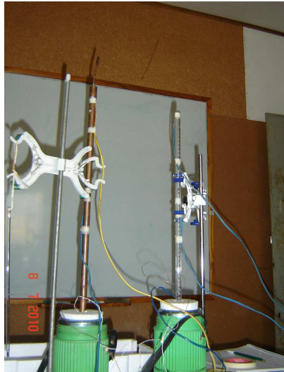
Figura 1. Disposición experimental de los tubos, del termo y las termocuplas de medida.
