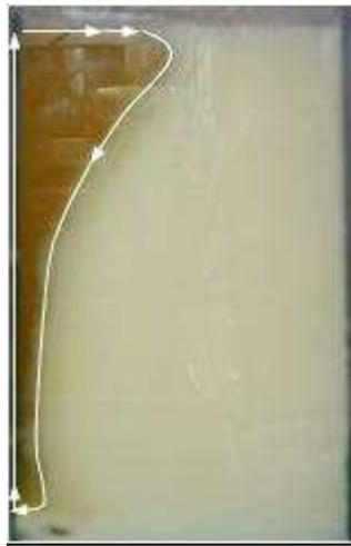
Figura 10: .Esquemización del ciclo de convección más sencillo en el proceso de fusión de una grasa vacuna.
