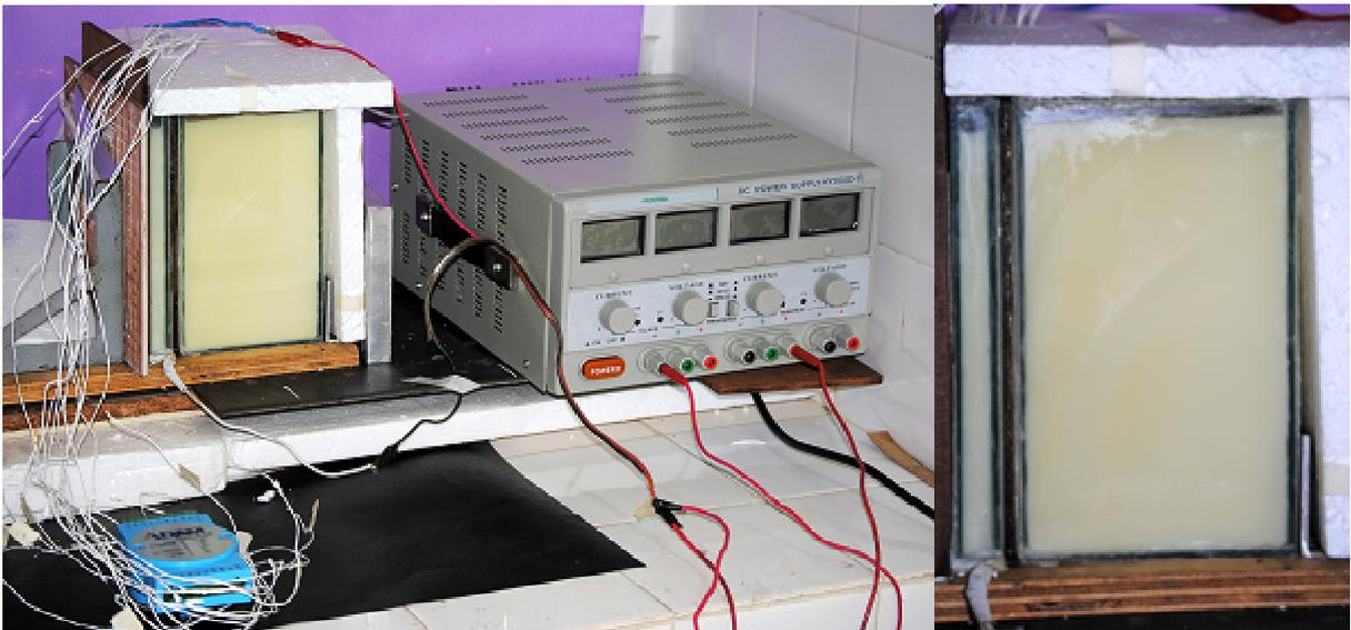
Figura 1: Izquierda: Dispositivo experimental que se empleó en los ensayos. Derecha: Recintos, calefactor y aislación.
