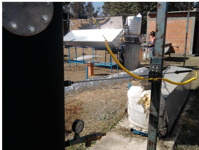
Figura 3: Foto de los instrumentos de medición del recinto, manómetro y termómetro digital
