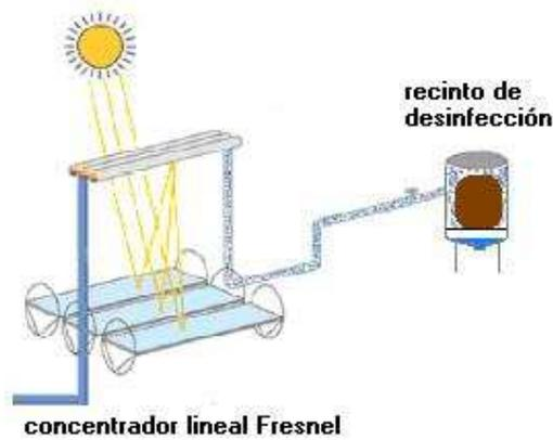
Figura 1: Esquema del equipo de desinfección solar
