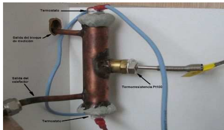
Figura 5: Detalle del bloque de medición de temperatura
