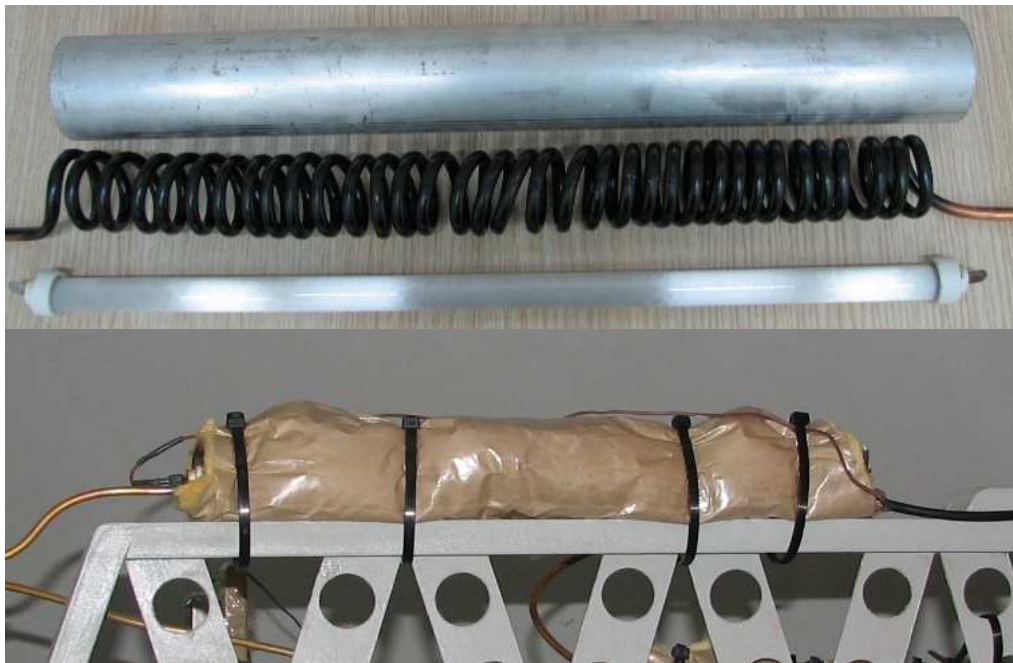
Figura 4: Detalle de los componentes del calefactor y conjunto armado
