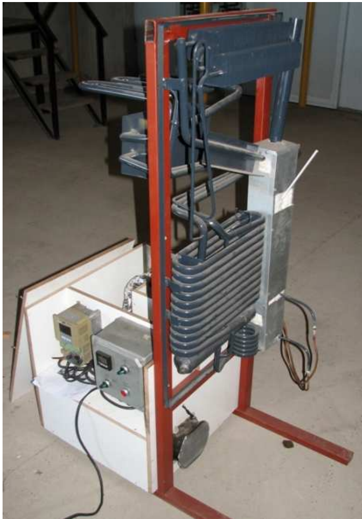
Figura 10: Sistema de calentamiento y ciclo de refrigeración
