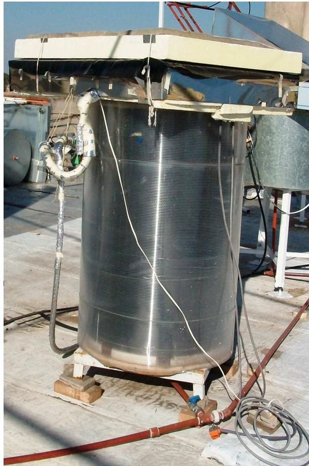
Figura 1 Imagen del destilador solar colector acumulador convertido en CSA con la cubierta superior construida con una placa de poliestireno expandido. En el lateral izquierdo se puede ver el conducto de recirculación usado para acondicionar y operar el sistema a las temperaturas de trabajo deseadas.
