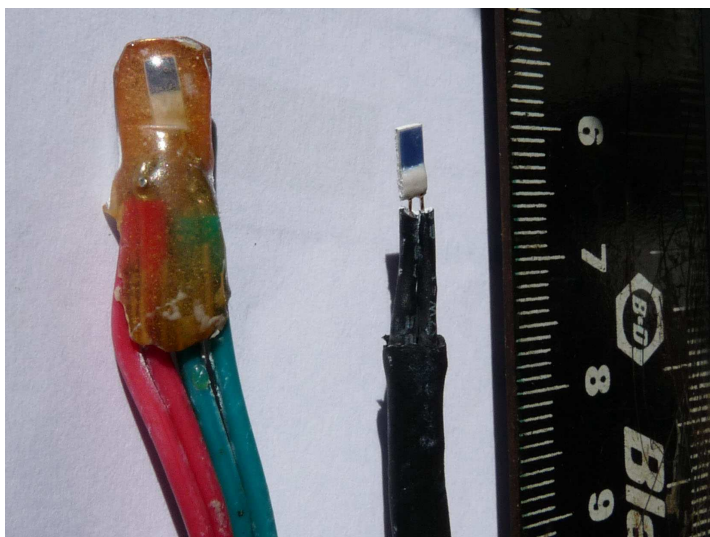
Figura 2: Sensores Pt100 utilizados para a medição de temperatura em módulos fotovoltaicos: à esquerda, Pt100 encapsulado, à direita, Pt100 não encapsulado. A marcação na régua da figura está em centímetros.
