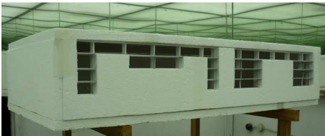
Figura 15: Vista exterior del modelo a escala en cielo celeste artificial.
