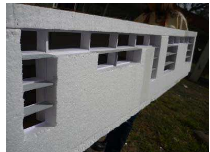
Figura 10: Vista exterior de la verificación de asoleamiento en maqueta del aula
