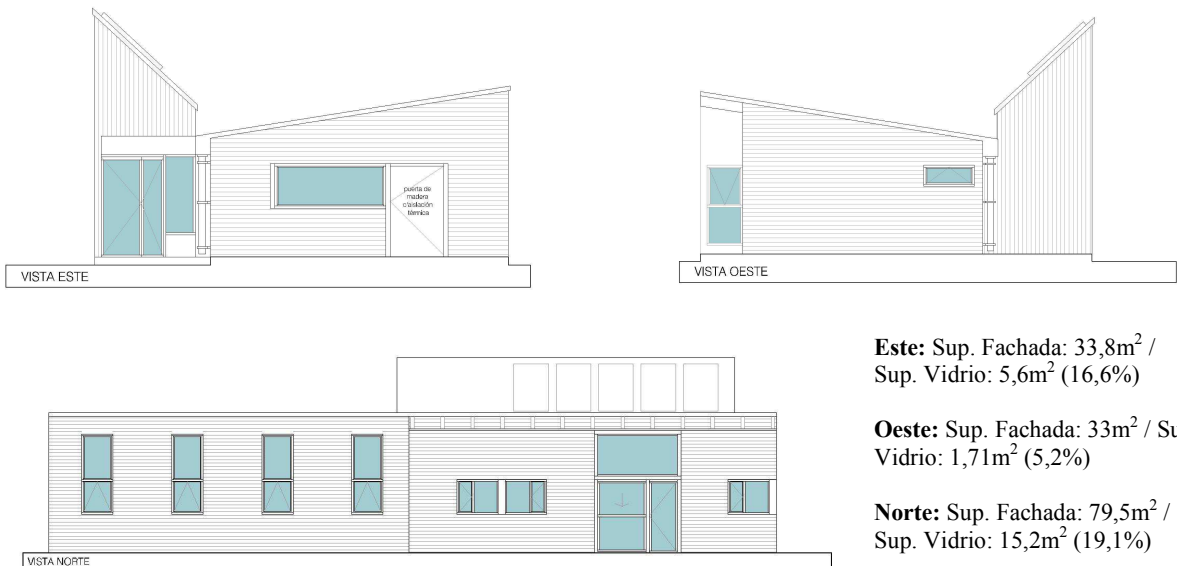
Figura 12: Fachadas Este, Oeste y Norte con los paños vidriados sombreados
