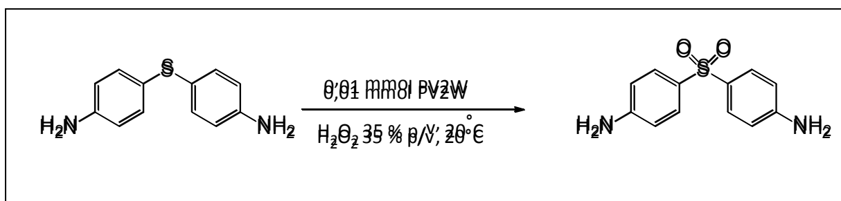
Esquema 9. Obtención de Dapsona a partir de la oxidación del sulfuro correspondiente utilizando las condiciones preestablecidas
