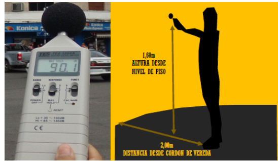
Figura 6. Sonómetro. Protocolo de Medición
