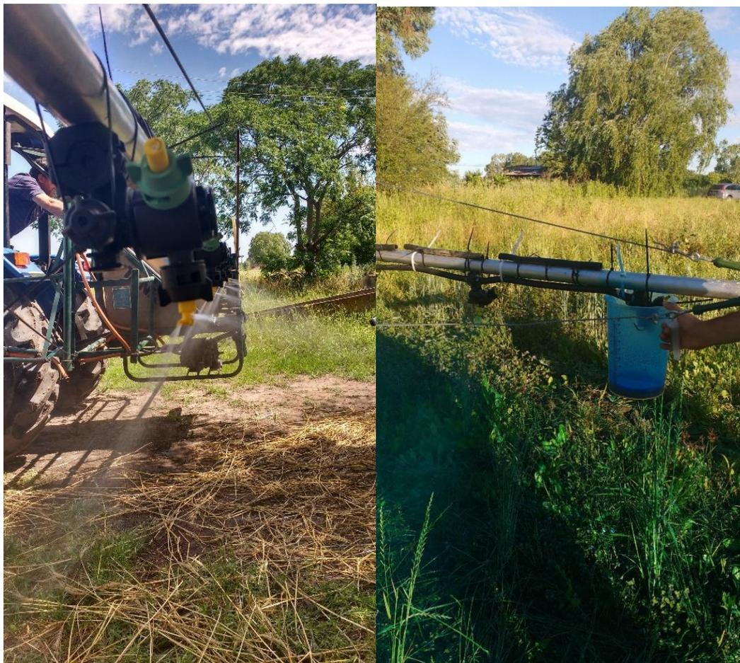
**Figura 3.** Estación Experimental Julio Hirschhorn. Calibración de la pulverizadora. a) Calibración de presión con pastilla AI3070 (angulación de 30° hacia adelante para hoja bandera, y 70° hacia atrás para espiga). b) Comprobación de caudal con trazador fluorimétrico.
