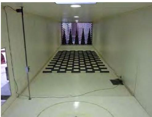
Figura 6: Vista de los elementos de rugosidad y de los *spires*.
