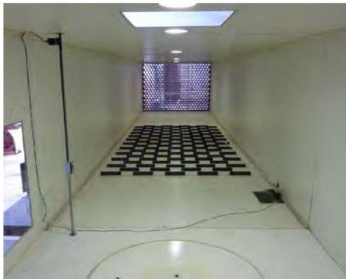
Figura 5: Vista desde la sección de prueba de elementos de rugosidad superficial.
