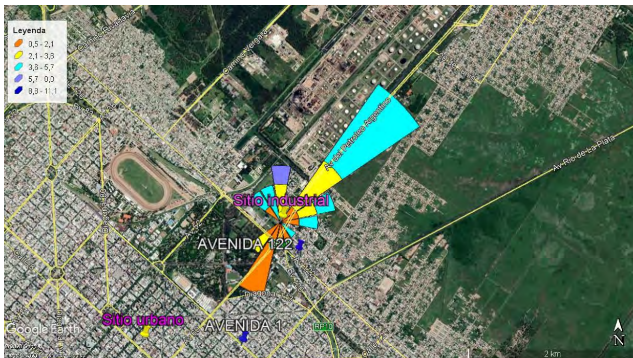
Figura 3.21 Rosa de los vientos del muestreo 51, insertada en el sitio industrial. La leyenda indica la intensidad del viento en \text{m s}^{-1} .
