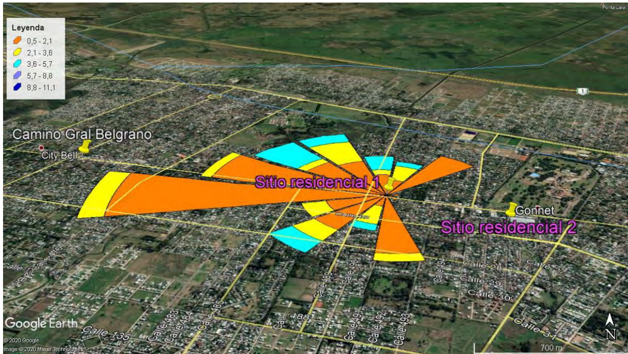
Figura 3.16 Rosa de los vientos del muestreo 7, insertada en el sitio residencial 1. La leyenda indica la intensidad del viento en m s^{-1} .
