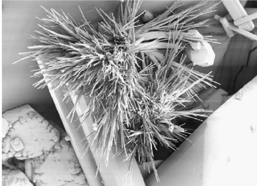
**Figura 1.6** Micrografía de Mullita.
