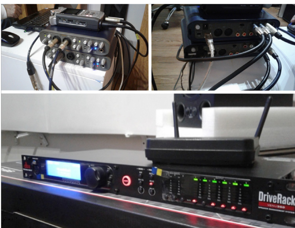
Fig. 3. Equipamiento usado en el flujo de señales para las capturas de las respuestas al impulso
