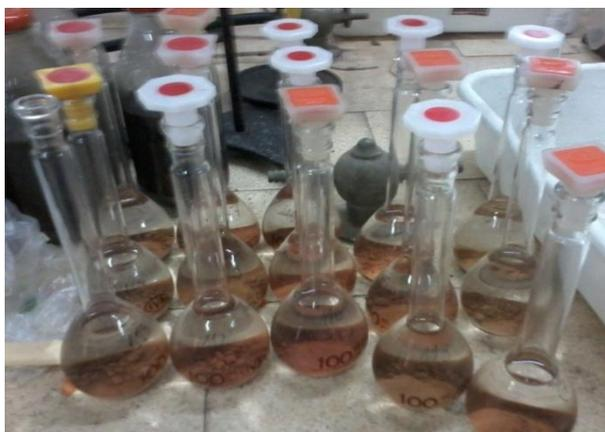
Figura 13. Digestión de cenizas de suelo con  $\text{HNO}_3$  0,2 N
