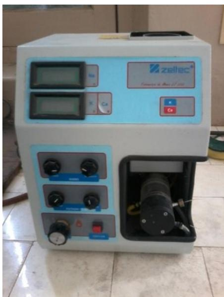
Figura 10. Espectro de llama para medición de Na y K.
