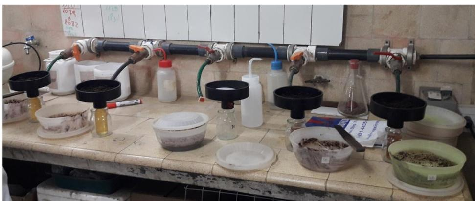
Figura 9. Obtención de los extractos de saturación de suelo.
