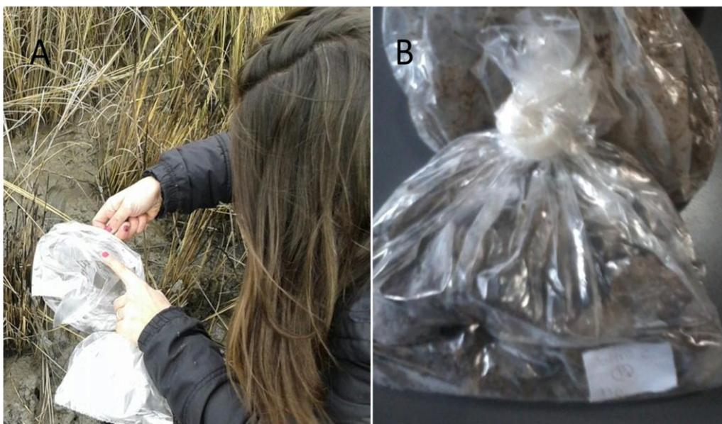
Figura 15. A) Obtención de las muestras de suelos. B) Conservación de las muestras en bolsas de plástico.
