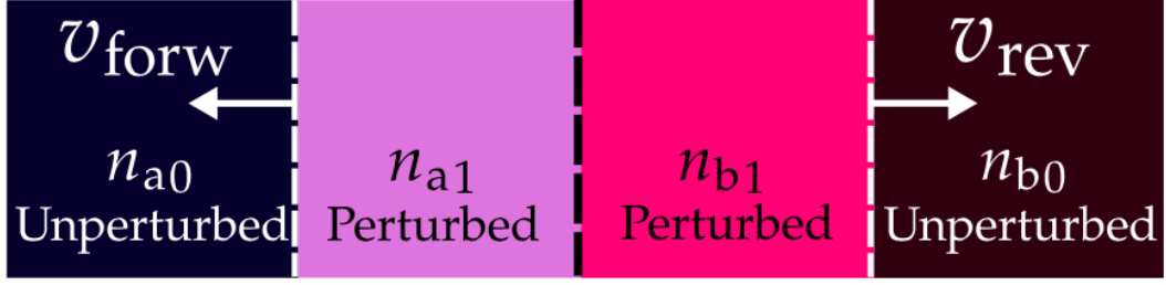
Figura 2.2. Esquema de cuatro regiones creadas por la colisión supersónica de dos gases. Las líneas punteadas blancas representan las ondas de choque. La línea punteada negra es la discontinuidad de contacto. Reproducido de Müller (2020).
