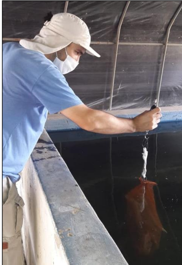
Figura 9: Determinación de peso al agua para el cálculo del porcentaje de materia seca y el porcentaje de almidón.
