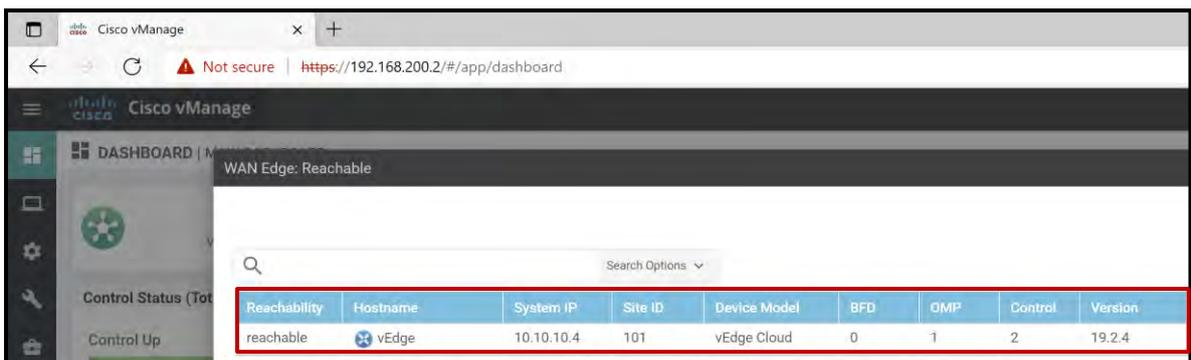
**Figura 4-155** Conectividad exitosa de vEdge Cloud a vManage- PoC SDWAN
