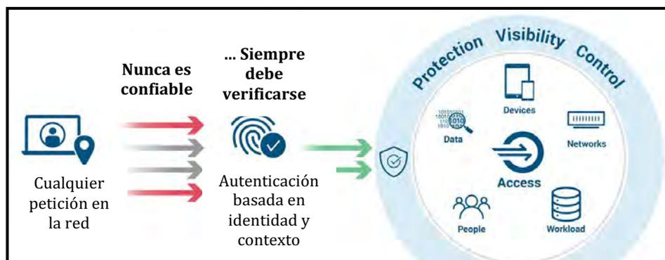
**Figura 3-26 Modelo de Seguridad Zero-Trust**
