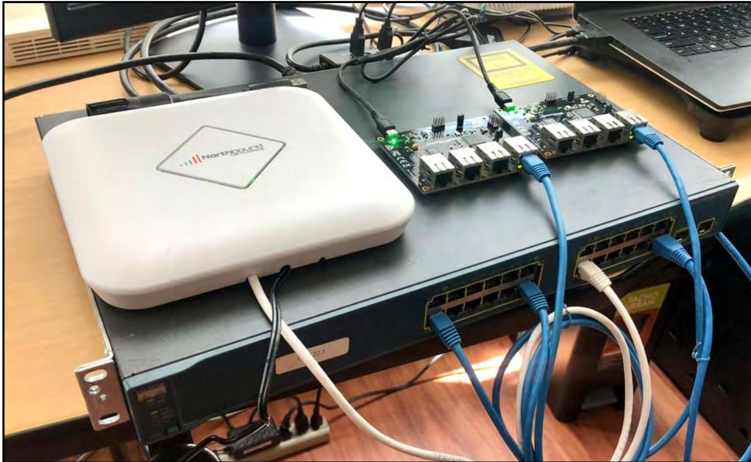
*Figura 5-6 Red Física SDN implementada mediante Zodiac FX(2), Zodiac WX y Controlador RYU - Inicio de Cableado
