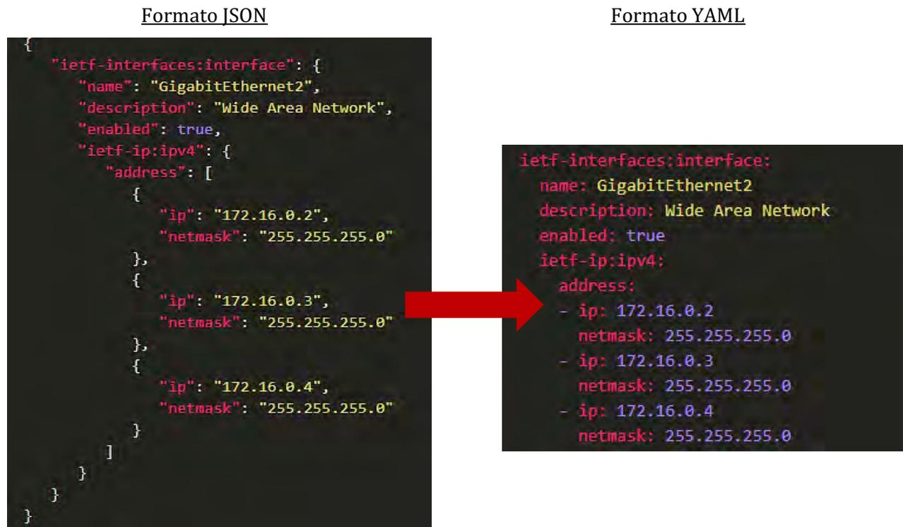
**Figura A - 4 Comparación Formato JSON vs Formato YAML**
