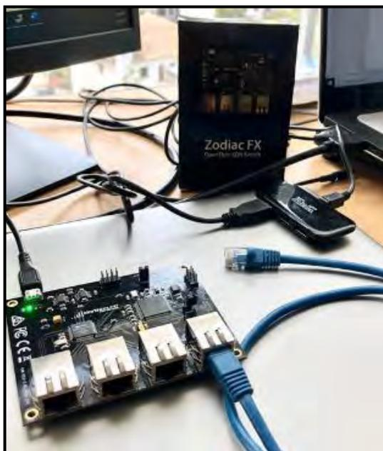
**Figura H - 3 Conexión y encendido inicial - Zodiac FX**
