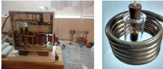
*Figura 3.18: Circuito resonante RLC generador del campo magnético de radiofrecuencia. Porta muestras (dewar de vidrio) respecto a las bobinas generadoras.*
