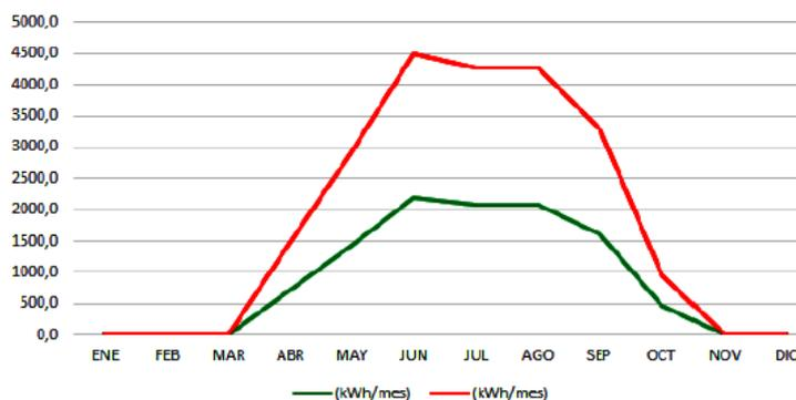
Fig. 10: Comparación de demanda de energía a termostato (20°C), entre versión original y mejorada a nivel mensual. Fuente: Elaboración propia
