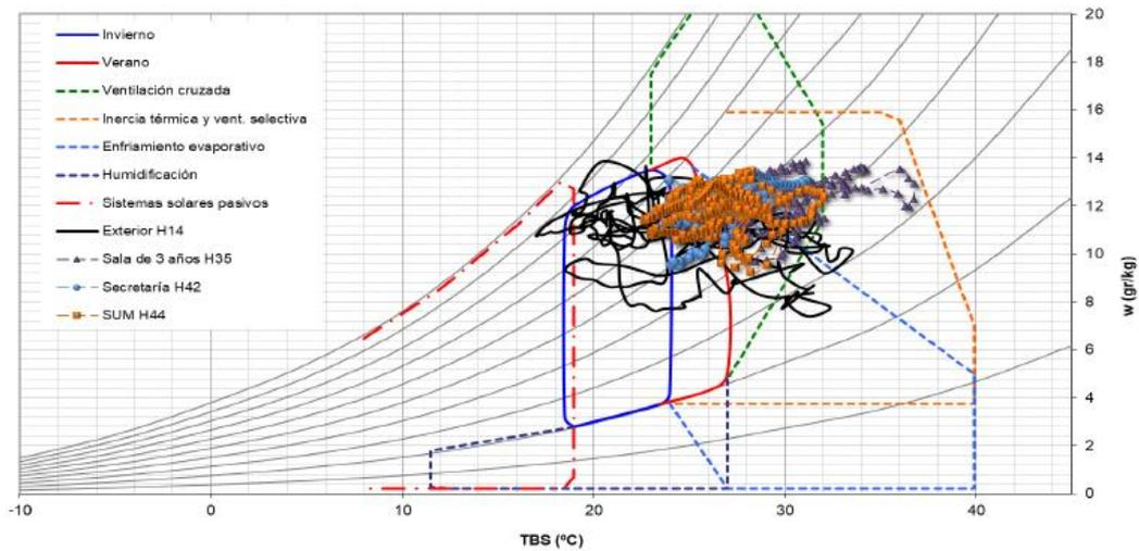
Fig. 7: Comportamiento higrotérmico en verano, del edificio, sobre un diagrama de confort de B. Givoni usando la App PsiConf 1.0. Fuente: Elaboración propia
