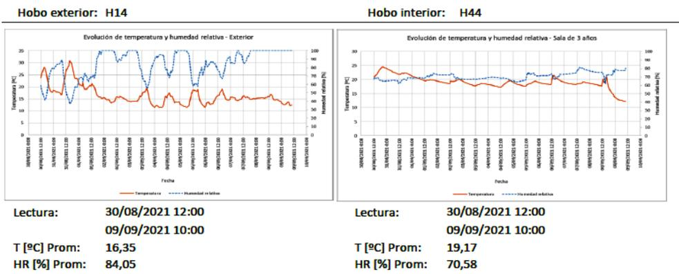
Fig. 4: Comportamiento higrotérmico entre exterior e interior del edificio en invierno. Fuente: Elaboración propia
