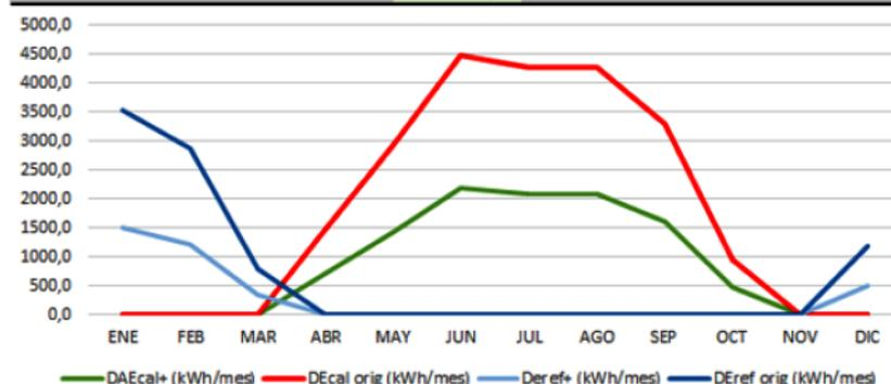
Fig. 14: Comparación de la demanda de energía anual mes a mes en calefacción y refrigeración del edificio original y mejorado. Fuente: Elaboración propia
