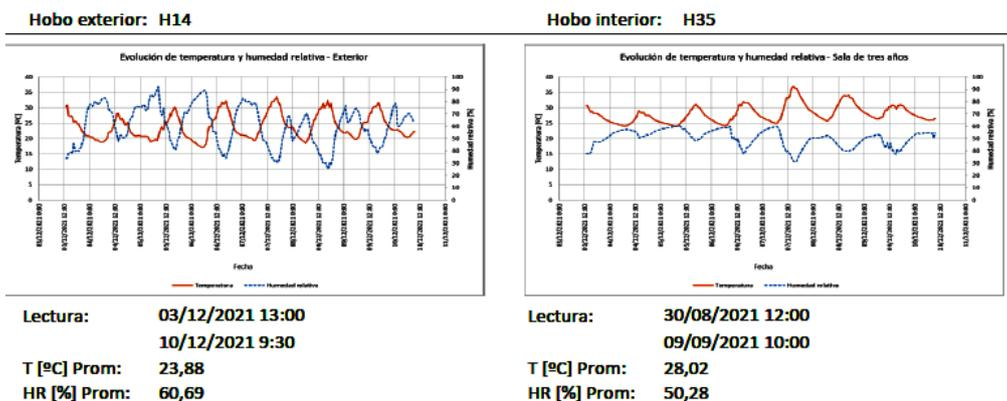
Fig. 6: Comportamiento higrotérmico entre exterior e interior del edificio en verano. Fuente: Elaboración propia
