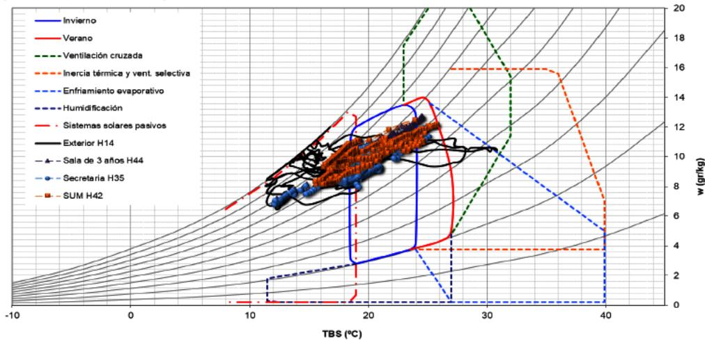
Fig. 5: Comportamiento higrotérmico en invierno, del edificio, sobre un diagrama de confort de B. Givoni usando la App PsiConf 1.0. Fuente: Elaboración propia
