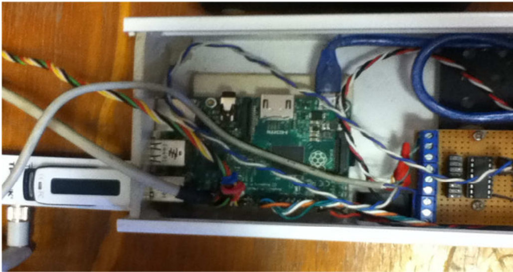
Figura 6: Sistema de medida y control basado en Raspberry pi.
