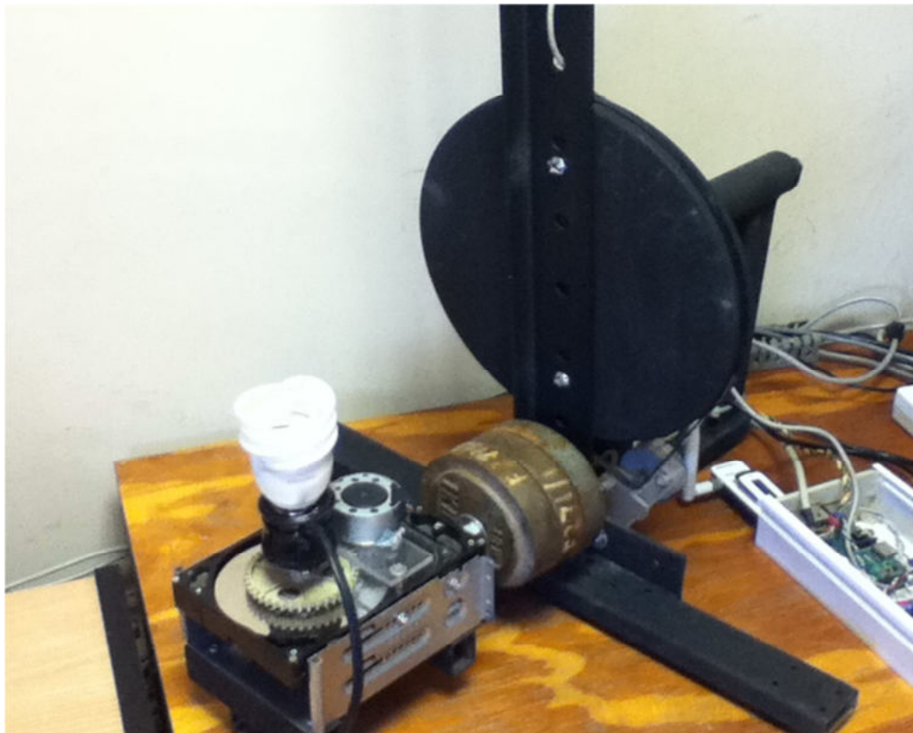
Figura 5: Fotografía del mecanismo de movimiento del sensor.
