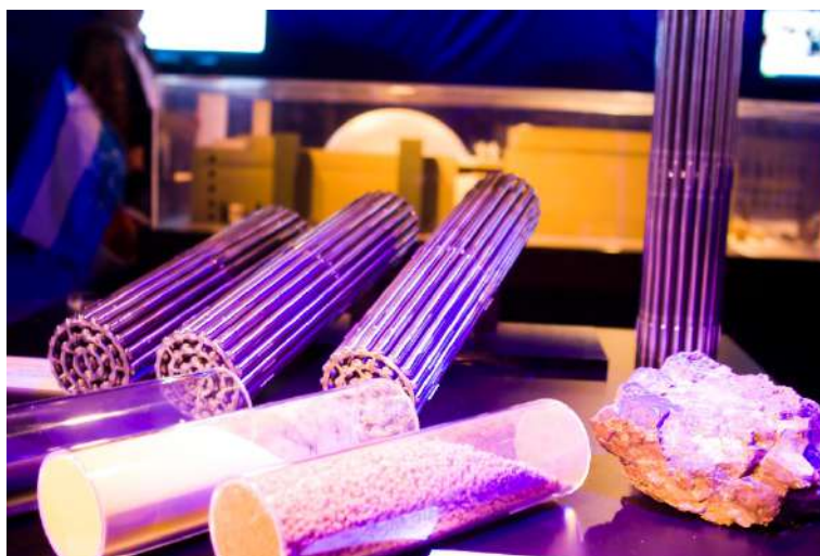
Ilustración 6: Muestras del Ciclo de Combustible Nuclear: roca mineralizada, tres etapas de purificación del uranio y combustibles nucleares tipo CANDU. Crédito de foto: Archivo CNEA
