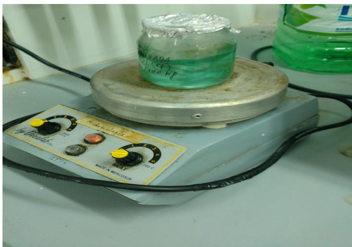
Figura 1: Semillas de trigo peleteadas en 100 ml de agua destilada estéril en agitador magnético.
