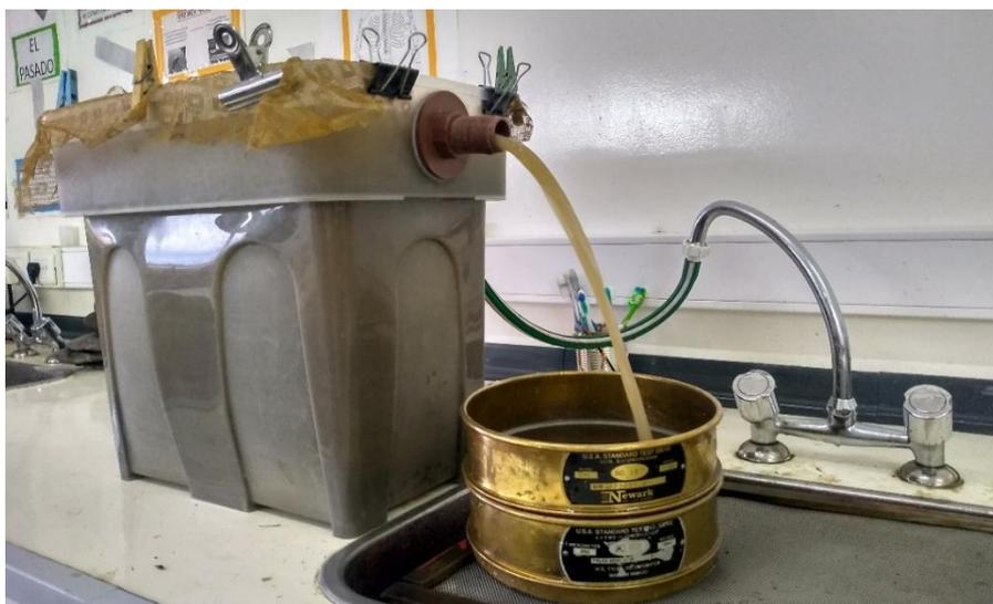
Figura 8.1. Sistema de flotación del sedimento por máquina asistida utilizado en la presente tesis, basado en Rodríguez-Ariza (2005) y Zapata y Peña Chocarro (2013).
