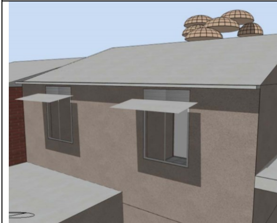
Figura 106. Aleros y rejillas superiores en ventanas
