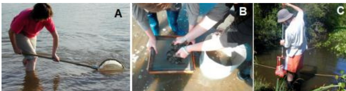
Figura 3. Muestreo sobre distintos tipos de sustratos blandos. A: copo aplicado para obtener organismos del bentos superficial en fondo areno; B: cilindro de 0,07\text{m}^2 de superficie, aplicado sobre sustrato blando y capa de agua no profunda; C: utilización de draga manual tipo “Ekman”, sobre sustrato blando.
