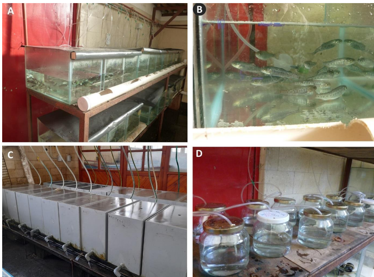
Figura 5. Sistemas de acuarios para experimentación con peces. A) y B) acuarios de vidrio completados con 10 L de agua de perforación y aireación constante. C) acuarios de PVC con provisión constante de agua. D) frascos de vidrio con tapa completados con 0,5 L de agua de perforación y aireación constante.
