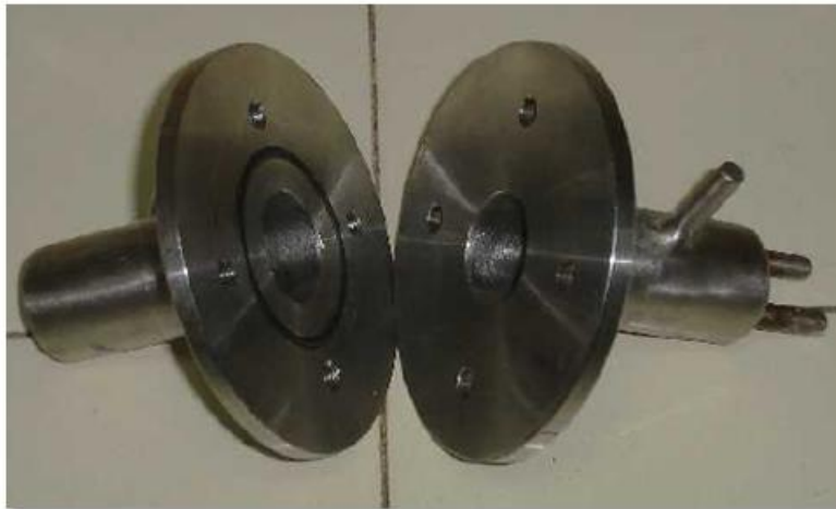
Figura 20. Celda utilizada en los ensayos de permeabilidad al CO_2
