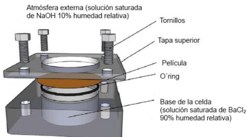
Figura 19. Esquema de la celda utilizada para determinar la P_w^{exp} en películas
