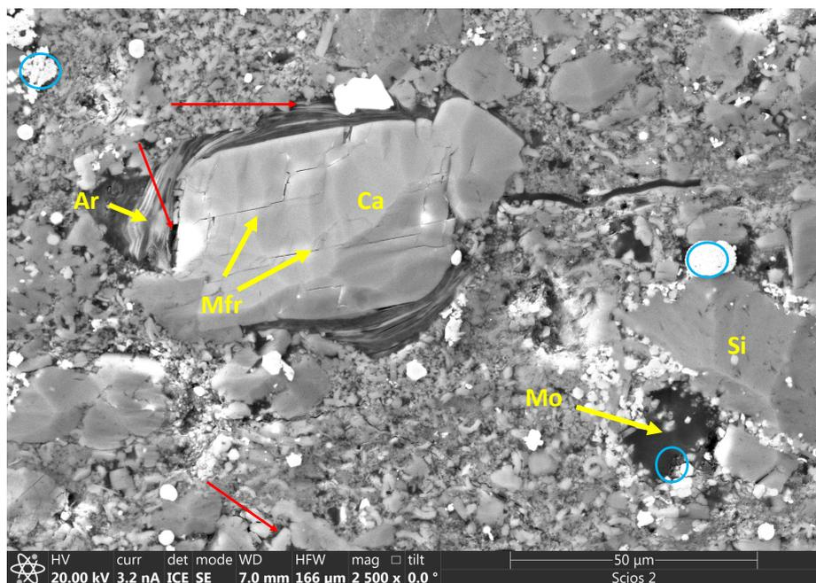
Figura 2.8: Una imagen de microscopía electrónica de la shale Vaca Muerta (Cuenca Neuquina, Argentina). Se observan clastos silíceos (Si), Carbonáticos (Ca), Arcillas (Ar). Se observan también regiones de materia orgánica (Mo) y microfracturas (Mfr). Con flechas rojas se indican regiones de porosidad intergranular, mientras que con elipses celestes regiones de porosidad intragranular y orgánica.
