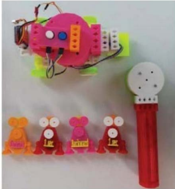
Imagen 32. Robot móvil, control de comandos e instrucciones (Meadthaisong & Meadthaisong, 2019, fig. 7)
