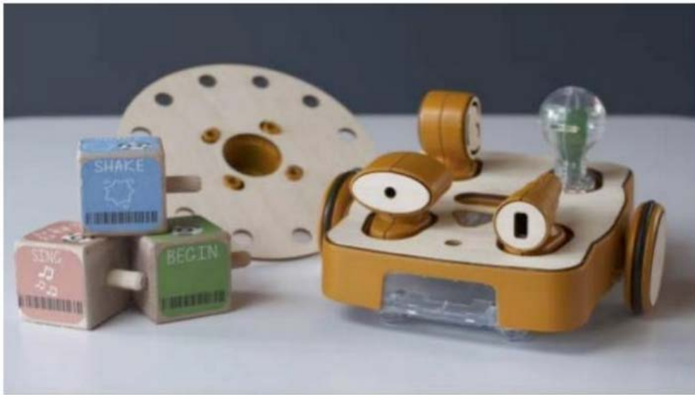
Imagen 17. Robot KIBO, plataforma de arte y tres bloques de programación (Sullivan et al., 2015, fig. 1)
