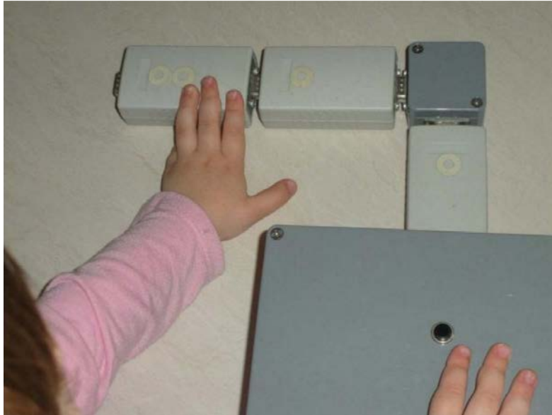
Imagen 4. T_Butterfly: caja maestra y cubos utilizados para programar de manera tangible una mariposa virtual. Los comandos empleados: avanzar, girar a la izquierda, avanzar y avanzar dos veces (Sapounidis & Demetriadis, 2011, fig. 1)
