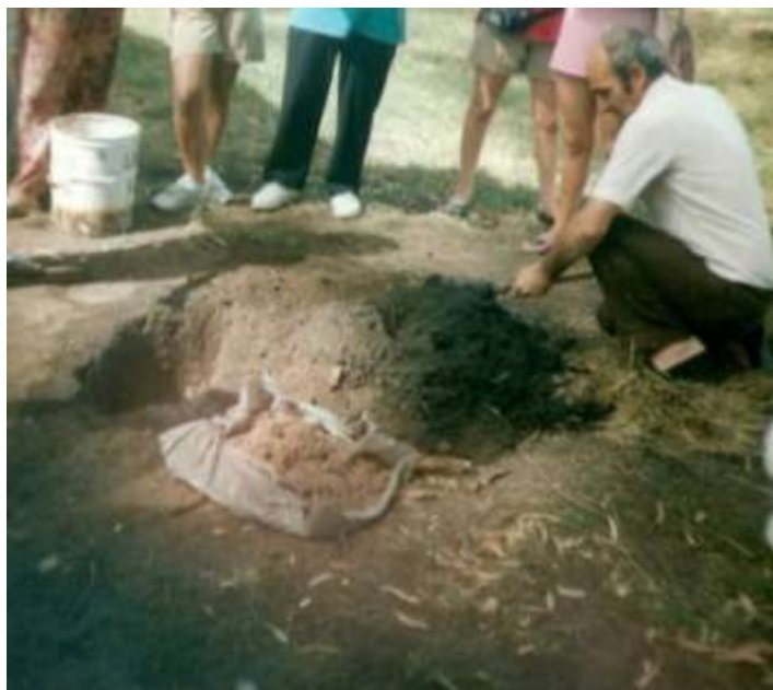
[Figuras 92] Preparación del pastón: con distintas arcillas, se va incorporando agua hasta lograr una determinada densidad.
