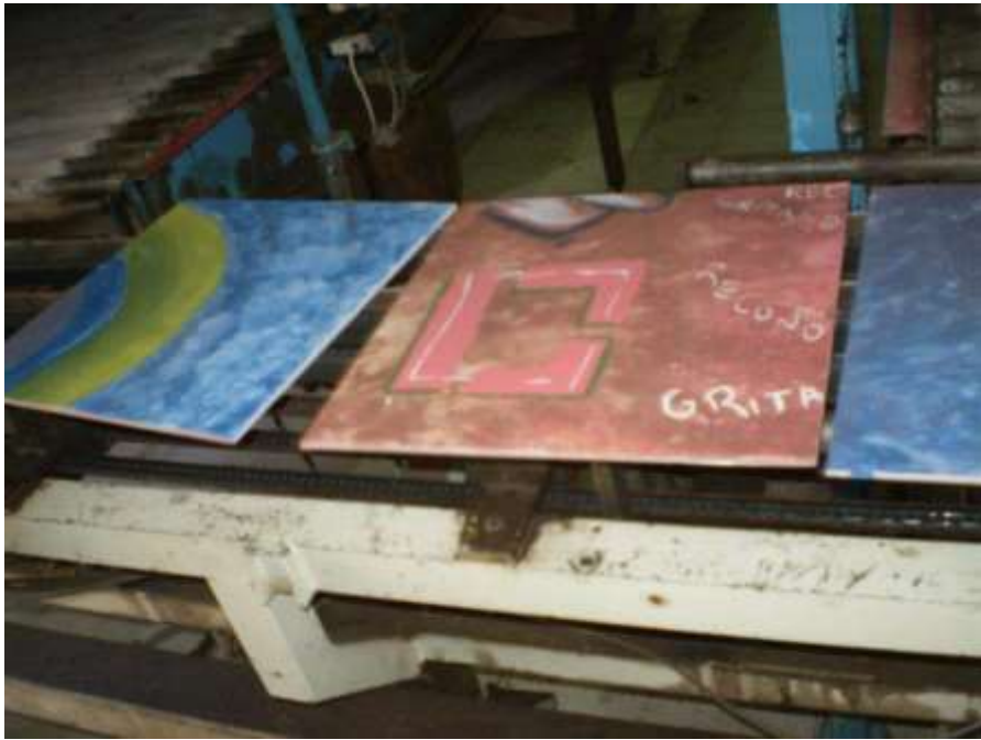
[Figura 121] Las baldosas entrando al horno continuo. Para ver todo el proceso xxx Fuente Fotografías y link del video gentileza de M. Simonovich
