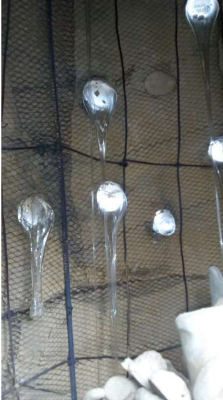
[Figura 61] Interior del horno luego de finalizada la horneada. El punto de fusión del vidrio es inferior al de la cerámica, por la fluidez resultan chorreadas los picos de las botellas.
