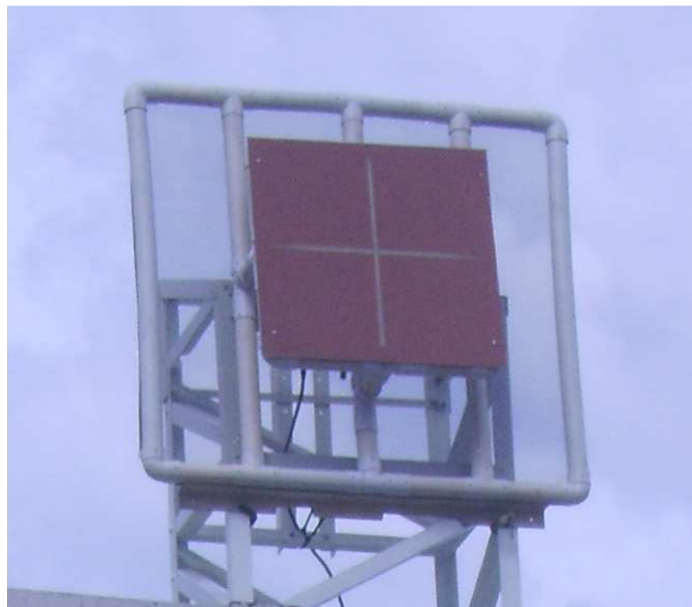
Figura 6.28: Modelo construido de la antena de ranuras cruzadas en material de circuito impreso.
