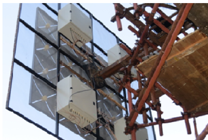
Figura 8.29: Agrupación de antenas instalada en la montura de medición donde se aprecian las cajas de procesamiento de señal y el sistema mecánico de movimientos.
