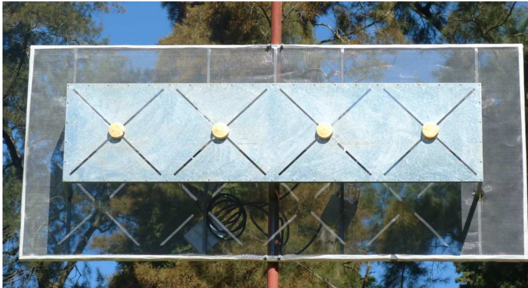
Figura 8.18: Prototipo experimental de la agrupación lineal construida con cuatro antenas de ranuras cruzadas.
