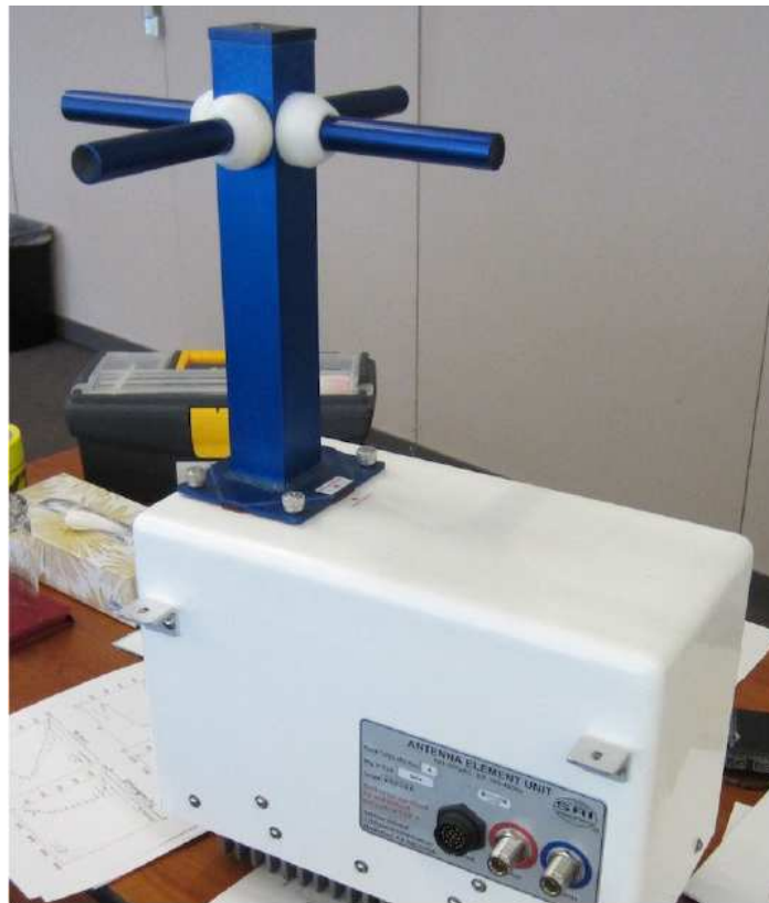
Figura 5.8: Antena dipolos cruzados y AEU (Antenna Element Unit) del radar AMISR [99].
