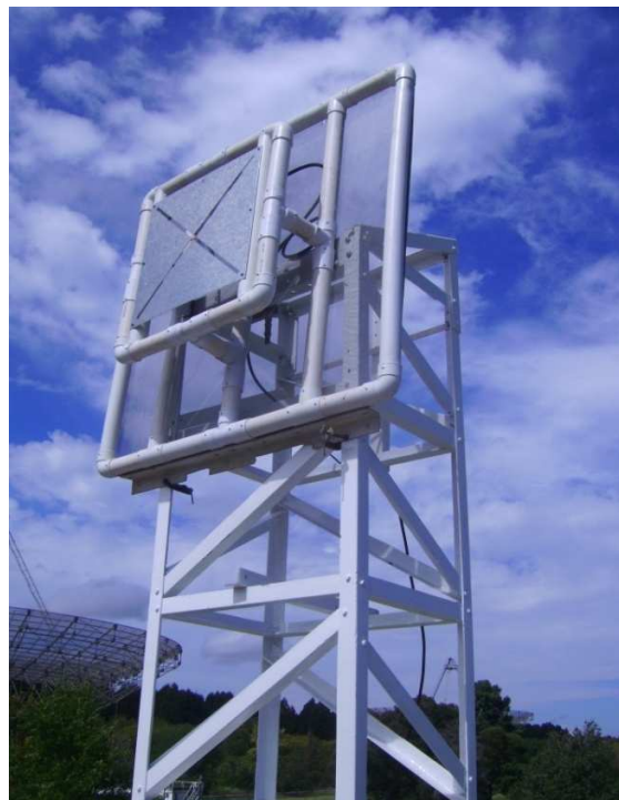
Figura 6.25: Modelo experimental de la antena de ranuras cruzadas en lámina metálica.
