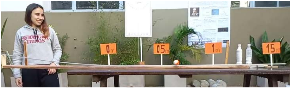
Figura 2. Plano con inclinación variable y con graduación de distancia.
