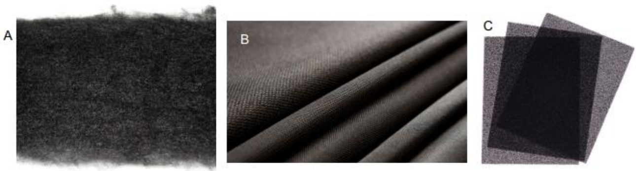
Figura 3.38: A) Fibras, B) telas y C) fieltros de carbón activado (Martín González, 2019).
