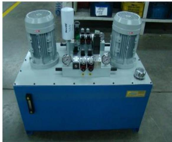
Ilustración 4 – Centralita hidráulica utilizada
